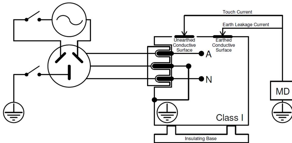
**PSEUDO EARTH LEAKAGE CURRENT TEST.**
